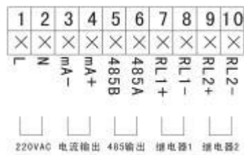
四线制 220VAC 供电接线图
