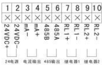
四线制 24VDC 供电接线图
