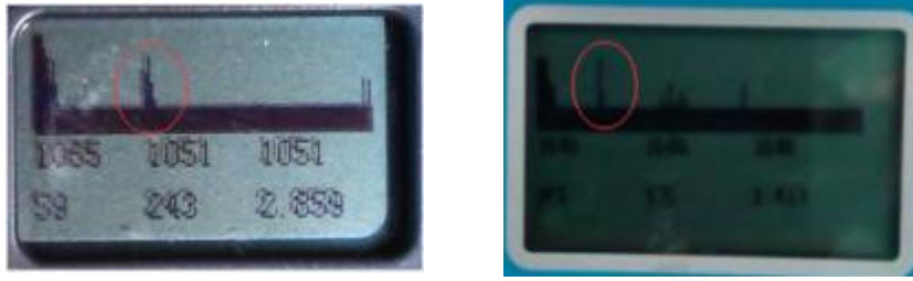
图5 正常的反射波信号
