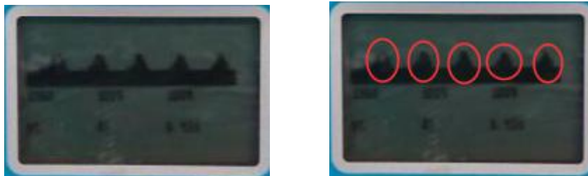
图7 变频器干扰的回波图形
