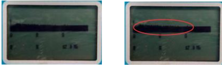
图6 电磁干扰的回波图形
