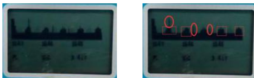
图9 变频器干扰的回波图形
