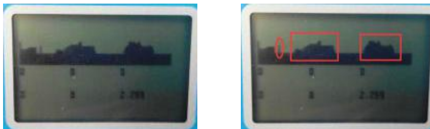
图8 变频器干扰的回波图形
