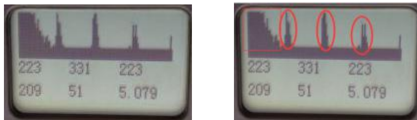
图1 共振形成的回波信号
