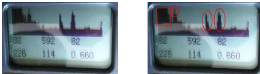
图3 进入盲区后出现的回波图
