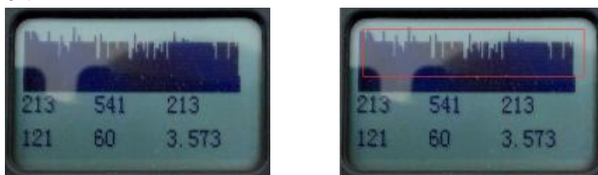
图10 强烈干扰的回波图形
