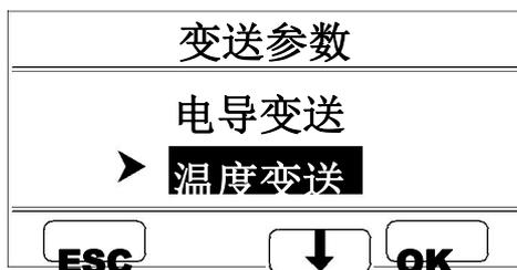
注：选择为“电导变送”或者“温度变送”后，参数自动链接到相应的显示单位，然后便可以进行 4-20mA 迁移量的设置。
